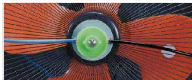
ノズルを扇風機の中央の位置へチューブが水平になるようマジックテープなどで貼り付けてください。
